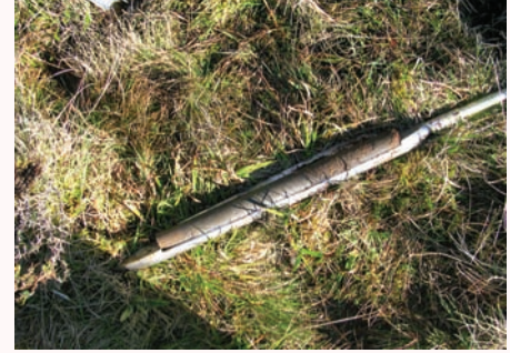
Foto 4. Muestra de turba extraída con sonda tipo rusa en la turbera de La Panera (Garganta la Olla)
