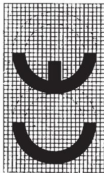
En caso de que el tamaño del marcado CE se amplie o reduzca en función del tamaño de la máquina, se respetarán las proporciones indicadas en el dibujo anterior. Los distintos elementos del marcado CE deberán tener básicamente la misma dimensión vertical, que no podrá ser inferior a 5 mm.
