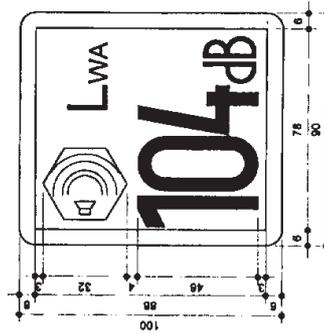
En caso de que la indicación se reduzca o se amplie en función del tamaño de la máquina, se respetarán las proporciones indicadas en el dibujo anterior. No obstante, la dimensión vertical de la indicación no será, en la medida de lo posible, inferior a 40 mm.
