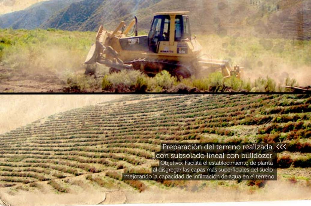
Preparación del terreno realizada con subolado lineal con bulldozer
