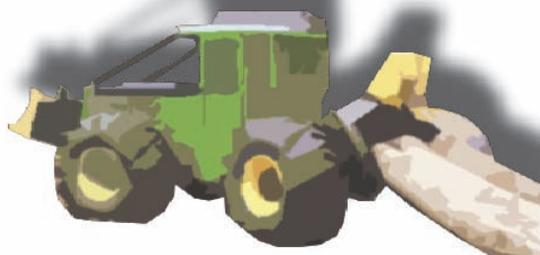
*Ilustración que simula a un Tractor Forestal realizando actividades de arrastre de madera. Muchos accidentes en el sector forestal son debidos a vuelcos inesperados de la máquina*
