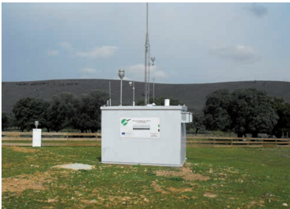
Figura 12. Cabina de calidad del aire y captador de partículas PM_{2.5} de la red REPICA en el Parque Nacional de Monfragüe.
