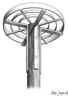
3. Colocación de plataforma circular con varios radios, con un cilindro en su base para encajar en el extremo del tronco, al que quedaría atornillado. Las ramas se amarrarán a la plataforma.
