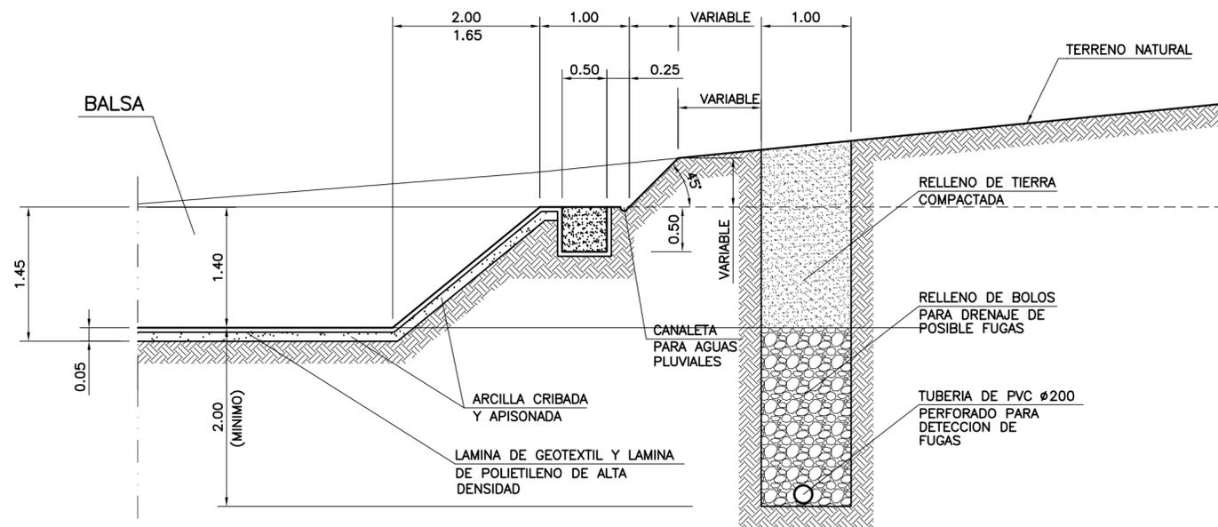
**DETALLE DE ARQUETA DETECCION DE FUGAS**
