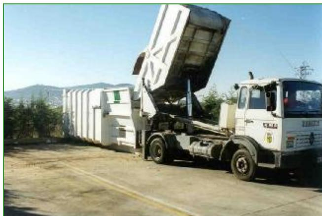
Figura 5.7. Vaciado de un camión en un Centro de Carga.
