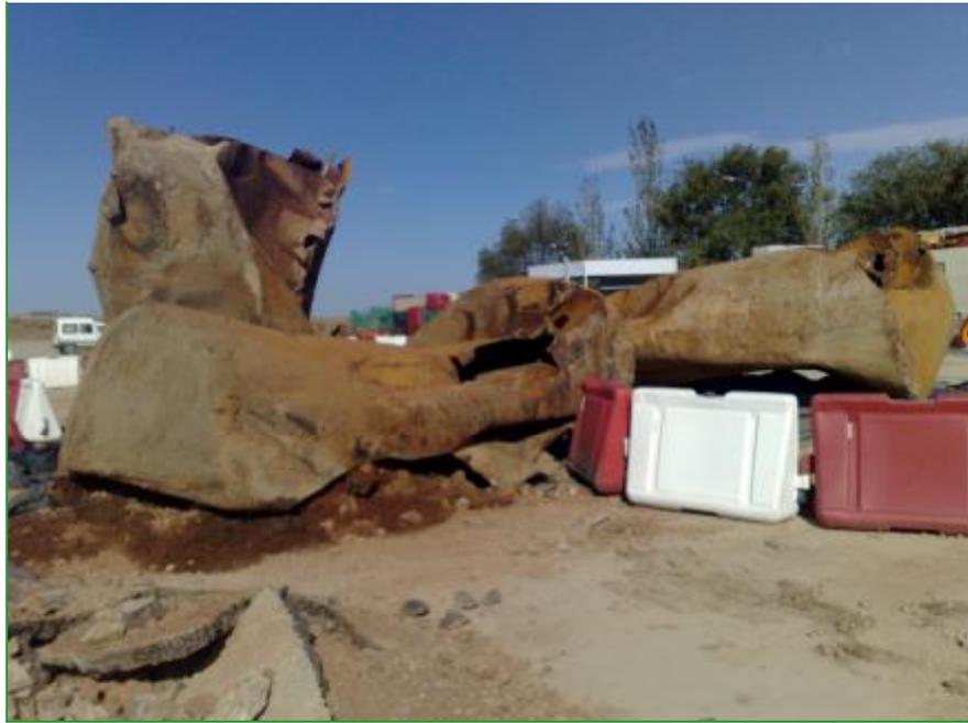
Figura 4.2. Tanques de combustible degradados (40 y 20 m<sup>3</sup>) en una estación de servicio abandonada.
