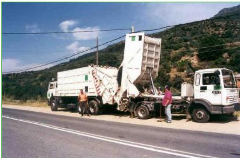
Figura 5.8. Camión de residuos municipales descargando sobre nodriza.
