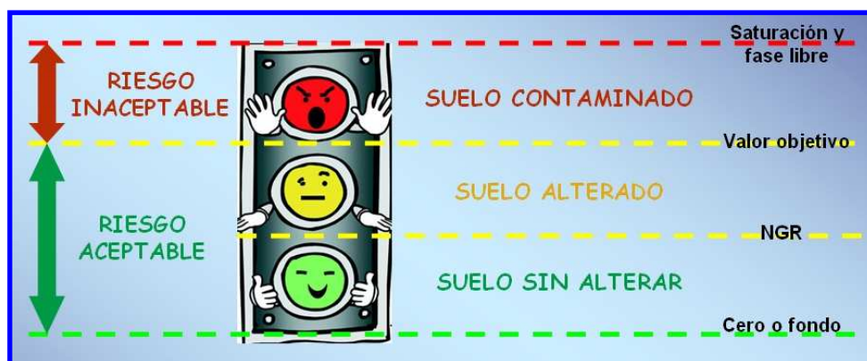
Figura 4.2. Concepto de suelo alterado, definiéndose como aquel en el que la concentración de contaminantes está por encima del umbral de referencia (NGR), pero que no representa un riesgo inaceptable para la salud humana o los ecosistemas.
