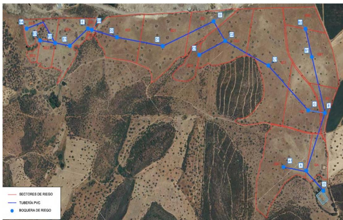
*Imagen 4. Sectores de riego y distribución de las tuberías de la red de riego.*
