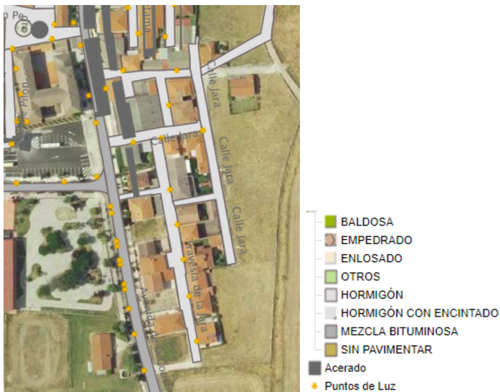
Fig. 30. Pavimentación y alumbrado. Fuente: Diputación de Cáceres
