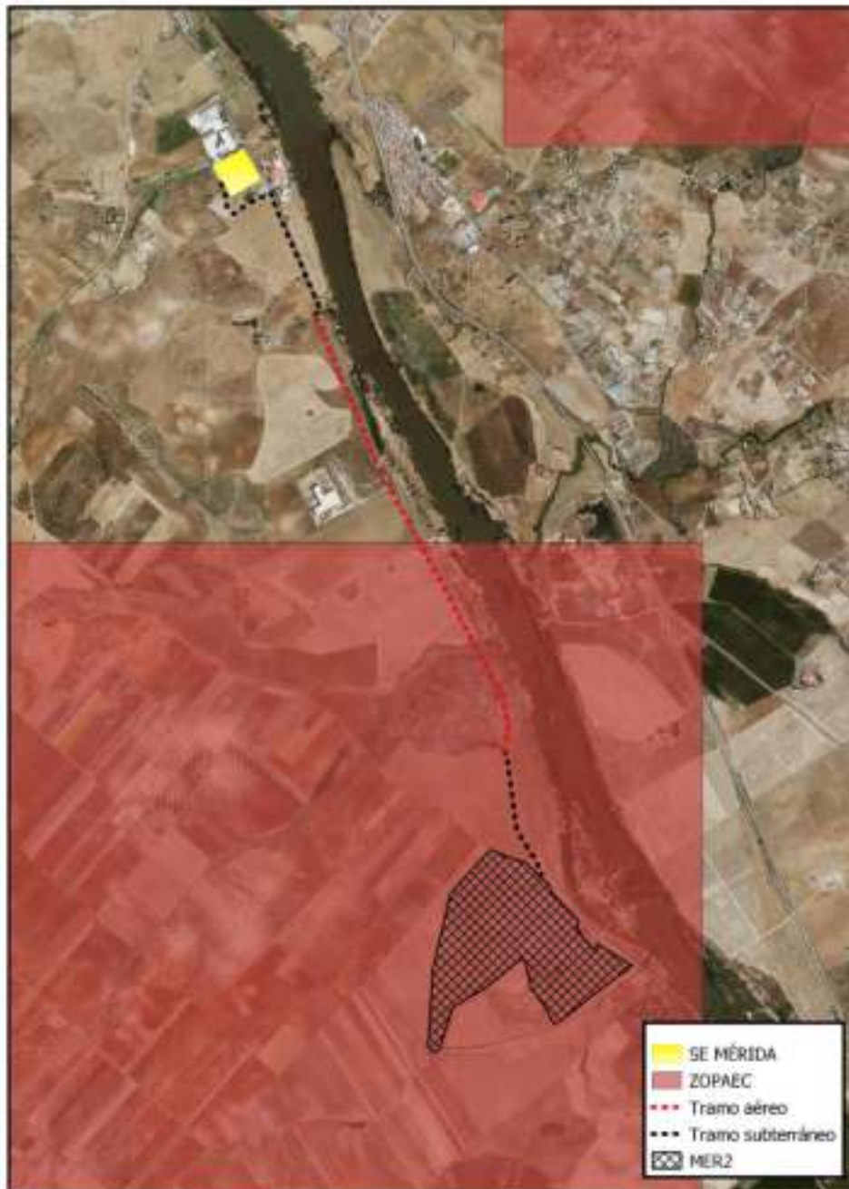
Ilustración 31. Trazado de la línea de evacuación.
