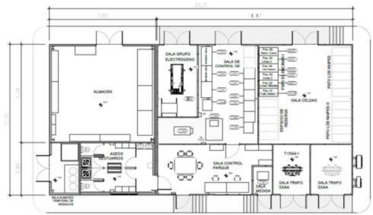
Ilustración 16.- Planta general del Edificio de Control.
