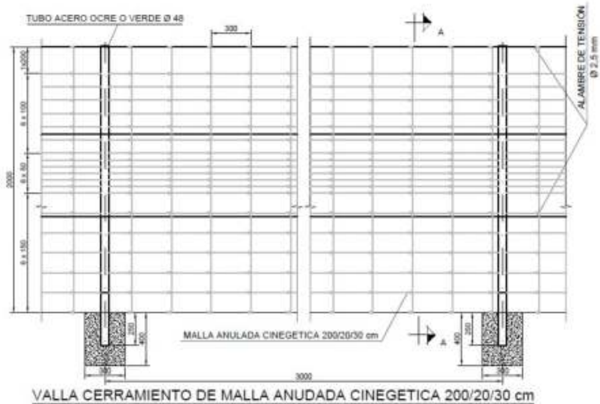
Ilustración 10.- Detalle del vallado perimetral
