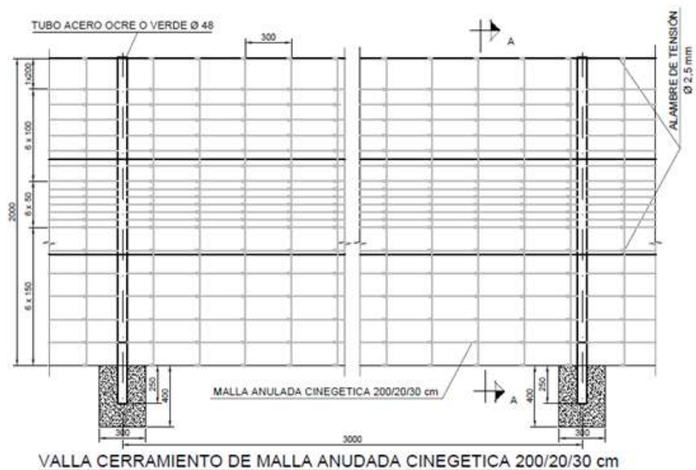
Ilustración 4.- Características del vallado perimetral.
