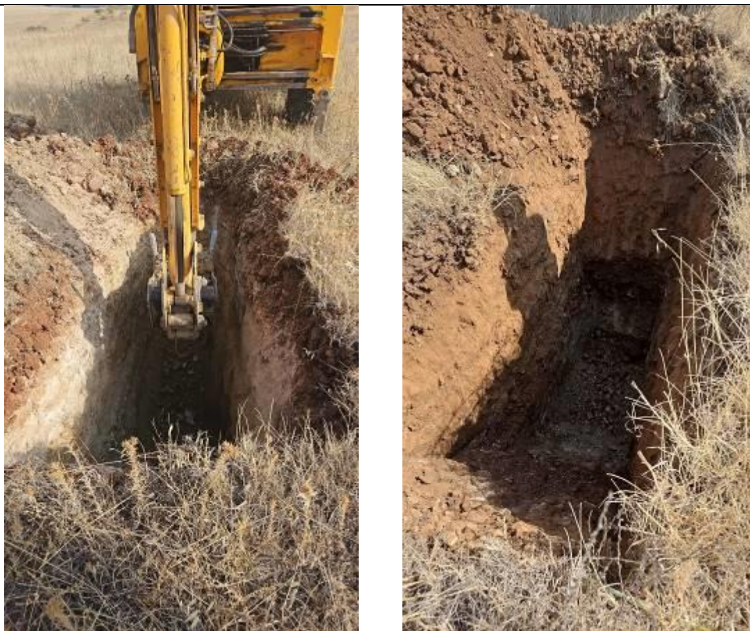
Prospección del medio edáfico en la zona del proyecto.
