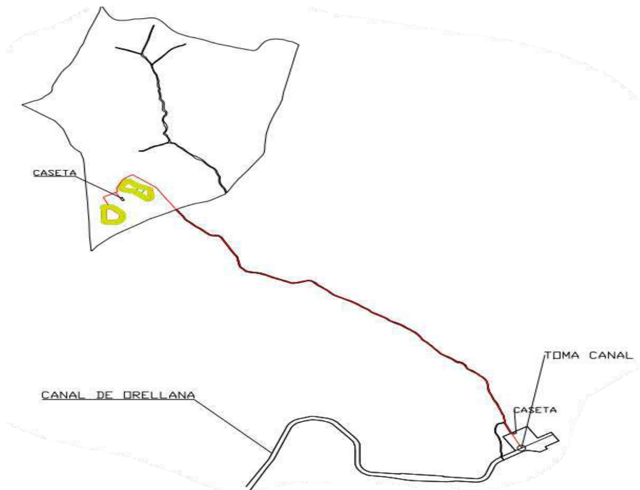
Imagen de la toma del canal y la impulsión hacia las balsas.
