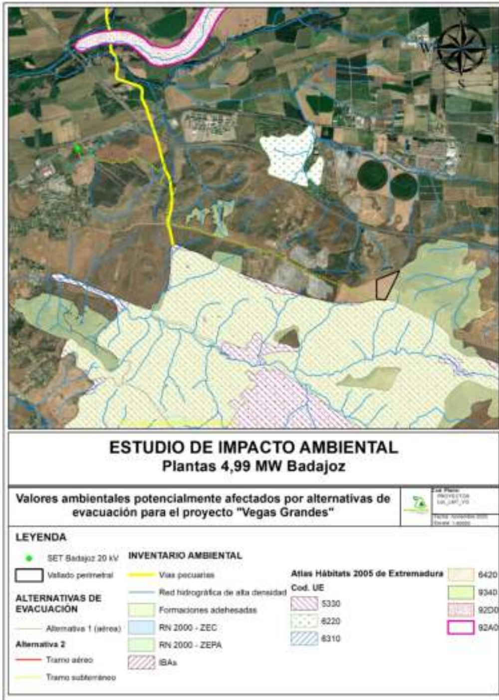
Ilustración 38.- Afecciones potenciales de las alternativas de evacuación.
