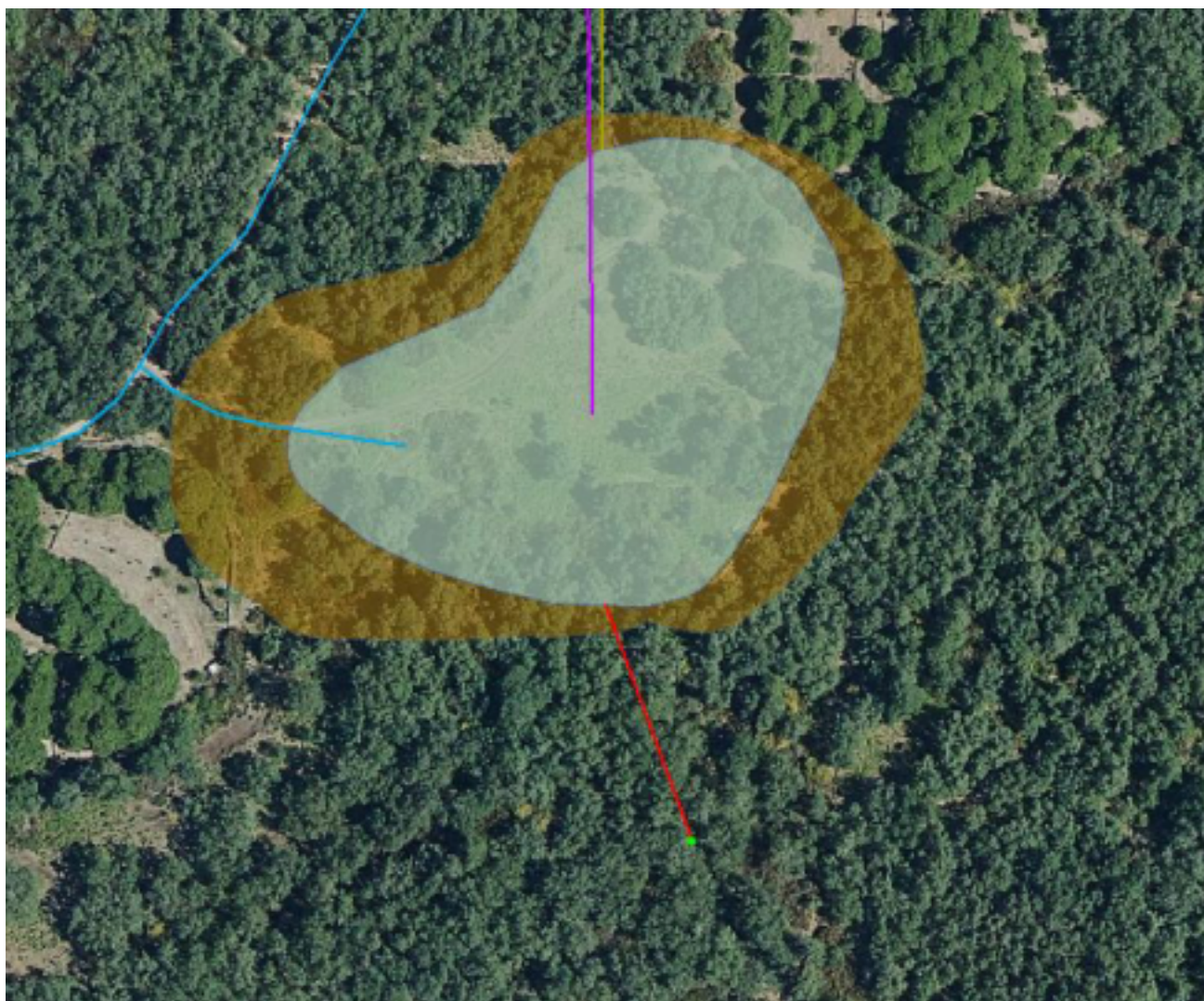
Figura 6: Tubería de llenado de la balsa (rojo)
