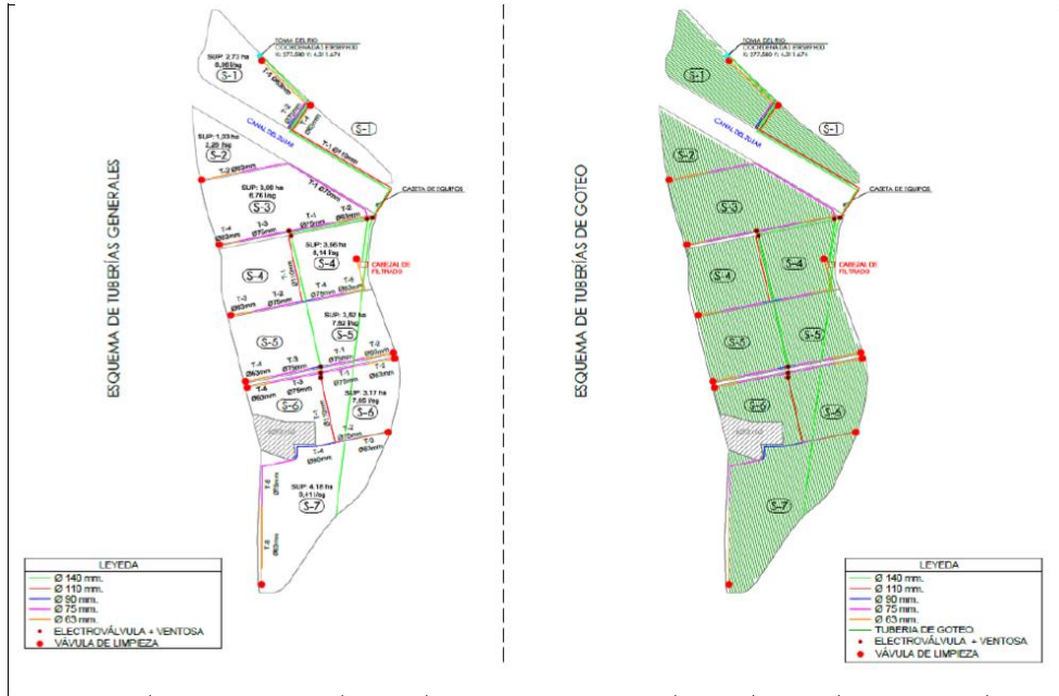
Figura 4. Red de riego y sectores
