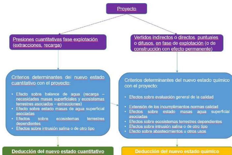
Figura 6. Secuencia lógica para determinar el nuevo estado final de la masa de agua subterránea con el proyecto
