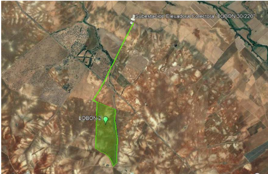
Ilustración 4. Plano interconexión "Lobón 2" a Subestación elevadora-colectora "LOBÓN 30/220"
