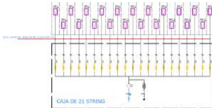
Ilustración 18: Caja de strings tipo de 21 ud
