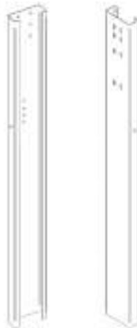
Ilustración 27: Perfil hincado para estructura y actuador
