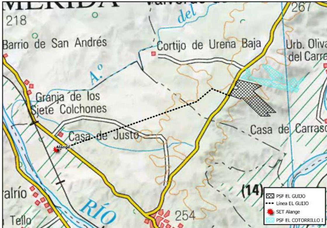
Este trazado tiene una longitud de 5,8 km y se plantea que sea de tipo aéreo.
