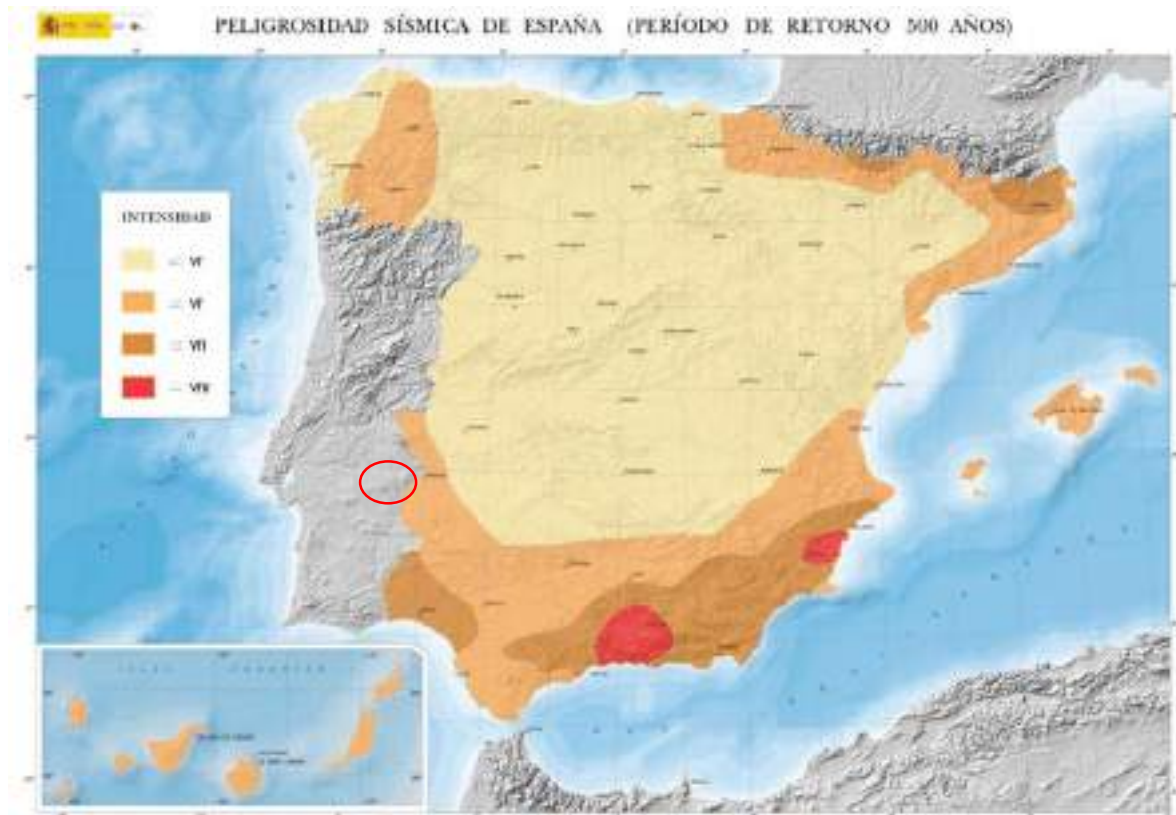
Ilustración 54: Peligrosidad sísmica en España
