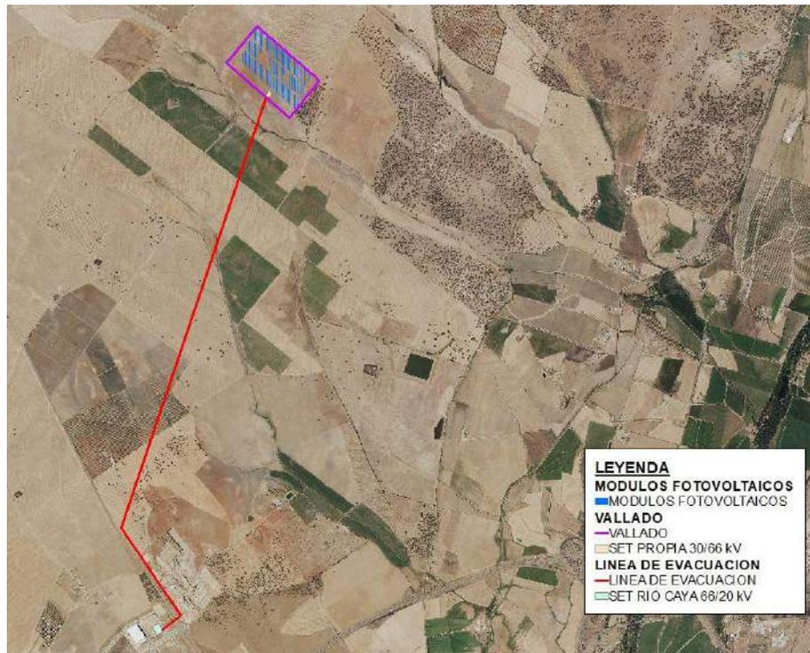
Ilustración 18: Implantación y línea de evacuación.
