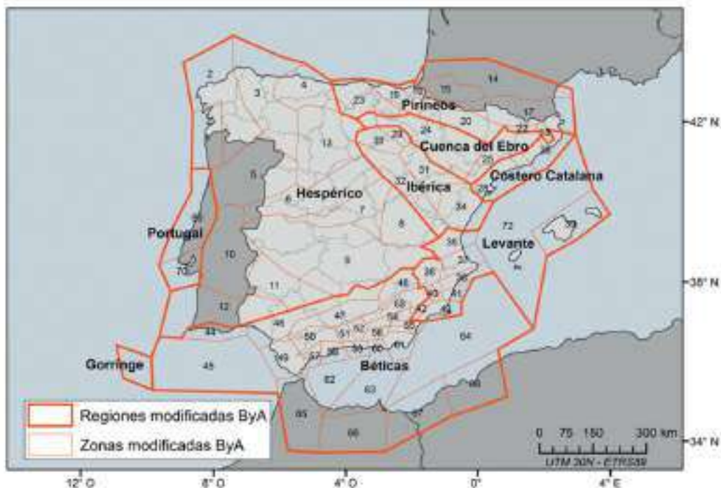
Figura 1: Zonificación de las regiones sismogénicas. (Fuente: PLASISMEX)
