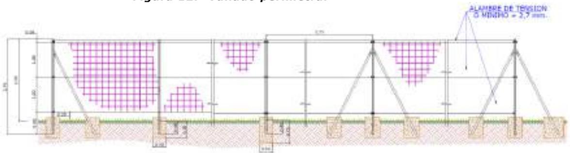
La excavación para cimientos de postes se ejecutará a lo largo de la alineación de la valla, para los postes intermedios se ejecutarán a 2 m de distancia entre ejes de postes de centro, mientras que entre poste de centro y poste de tensión será de 3,75m.
