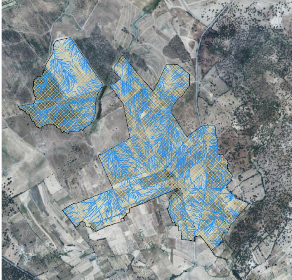
Figura 8. Flujos de escorrentía del interior de la planta.
