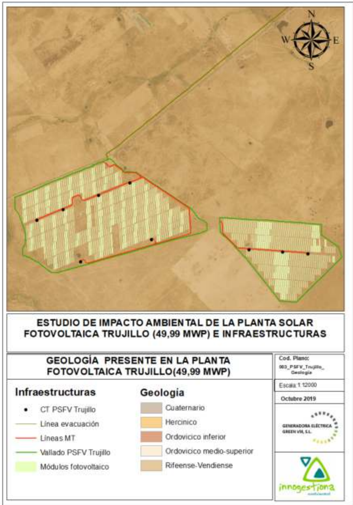
Ilustración 21.- Plano geológico de la zona de ejecución del proyecto. Fuente: Sistema de Información Territorial de Extremadura (SITEx).
