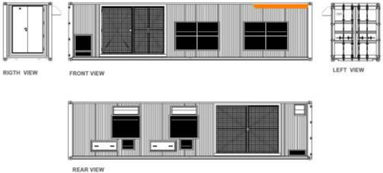
Ilustración 4.- Centro de transformación.
