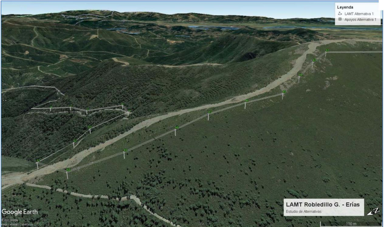
***Simulación Alternativa 1: tramo de apoyo 56 a apoyo 75***
