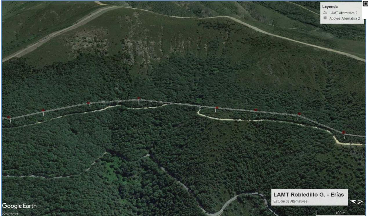
***Simulación Alternativa 2: tramo de apoyo 31 a apoyo 36***
