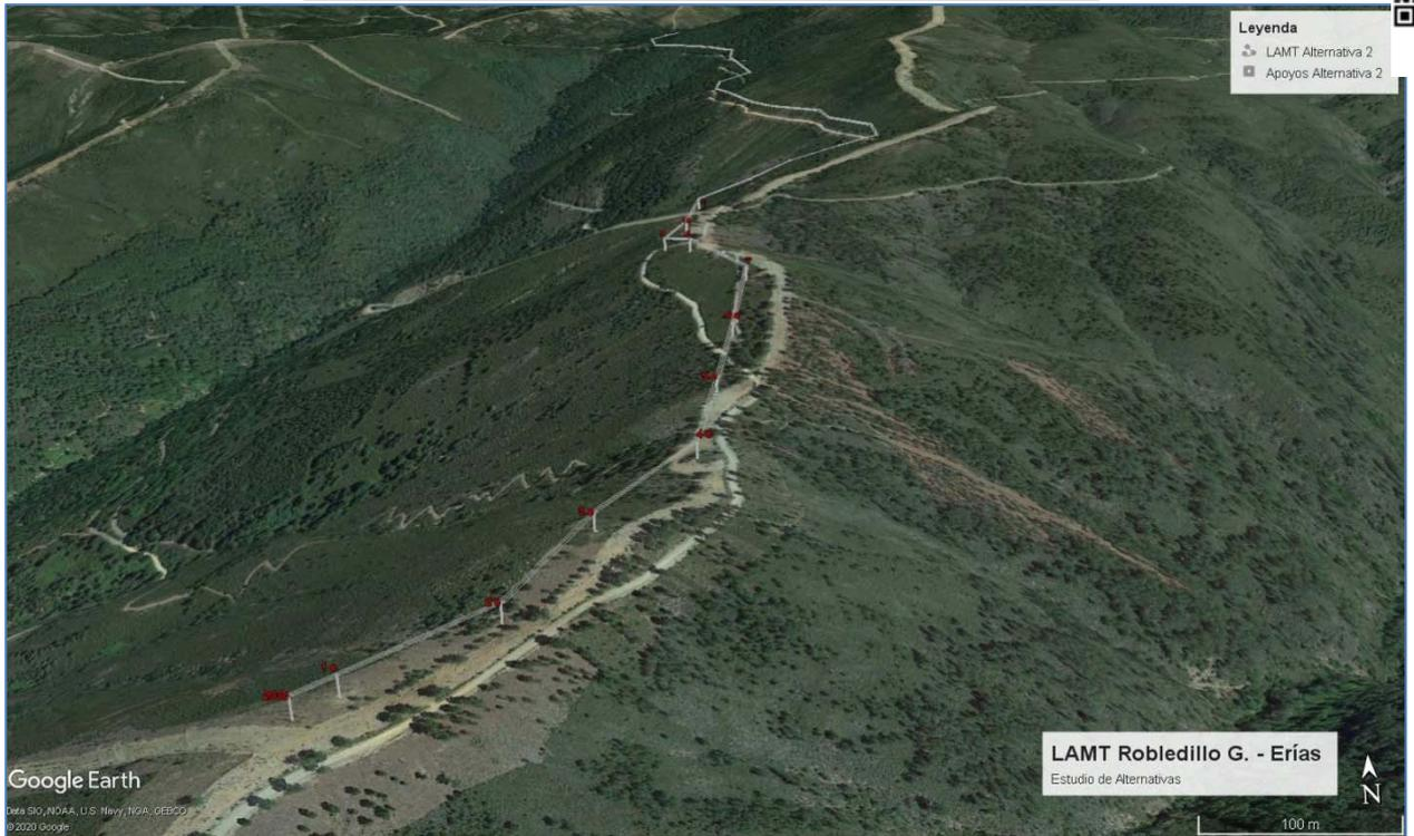
**Simulación Alternativa 2: tramo de apoyo 12 a apoyo 22**
