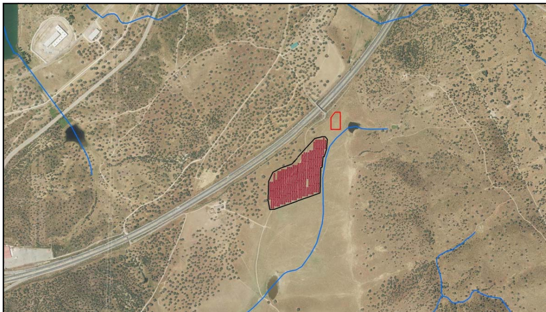
Figura 75. En azul, red hidrográfica en el entorno de la planta solar. En morado, ubicación de los seguidores. En negro, recinto vallado. En rojo, ubicación de la SET
