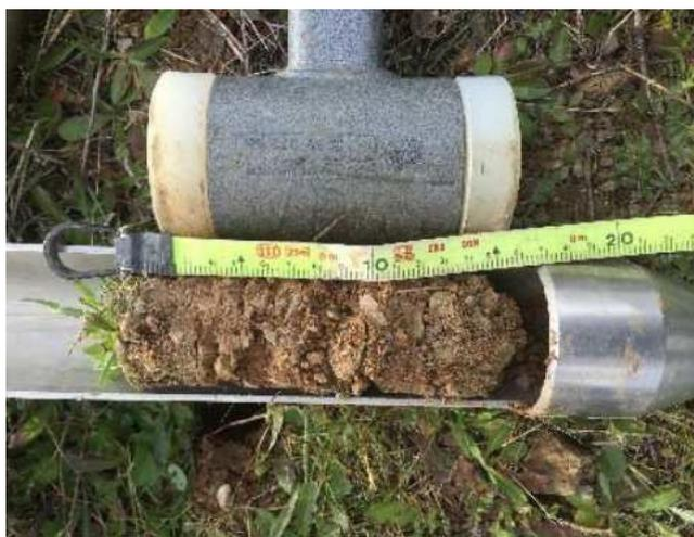
Detalle cilindro de suelo inalterado mediante barrenas
