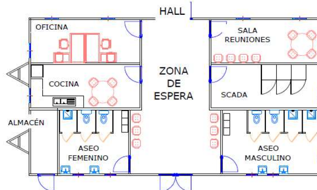
Figura 15.- Edificio Principal Distribución en planta
