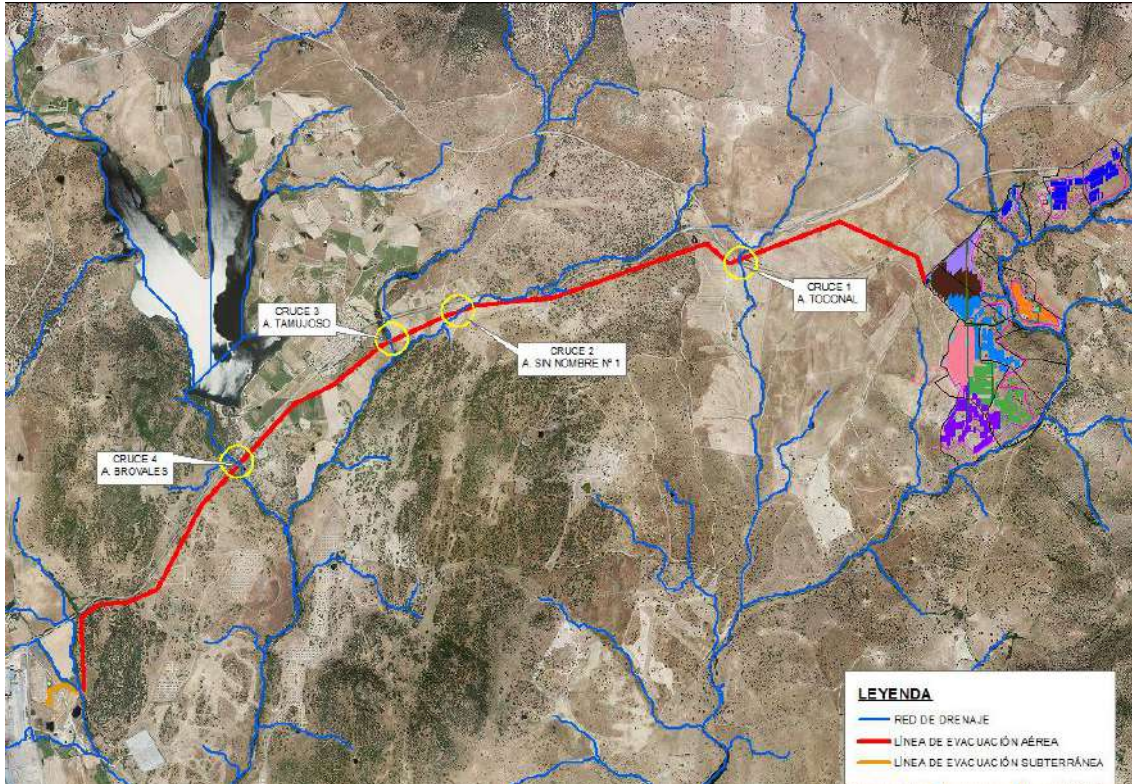
Figura 4. Cruces aéreos de la línea de evacuación
