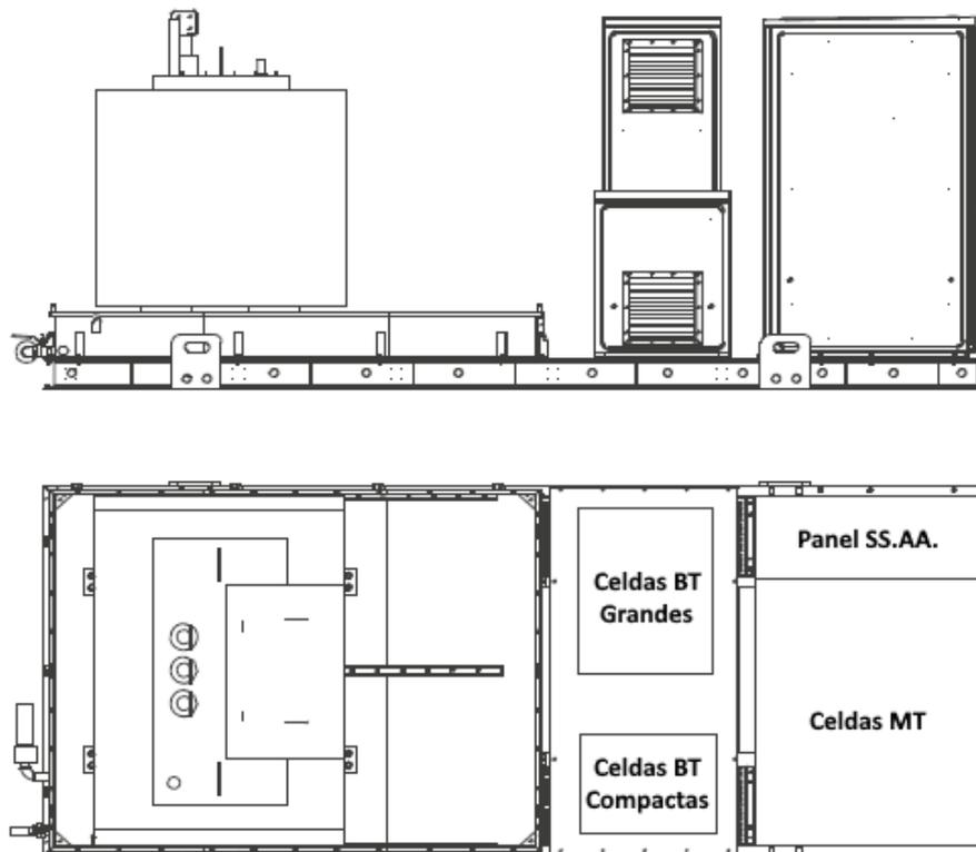
Figura 4.. 'Esquema de distribución de los equipos en el CT'. Fuente: IM2 ENERGÍA SOLAR PROYECTO 17, S.L.
