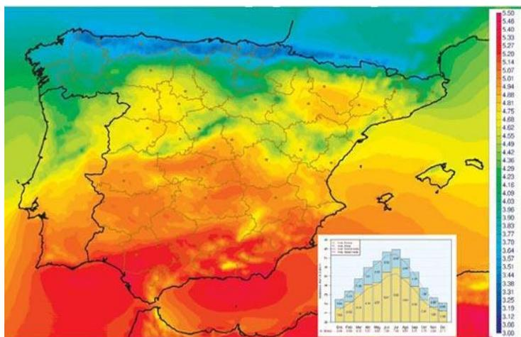
Figura 1. ‘Radiación Global media [1985-2005] (kWh/m<sup>2</sup>-día) SIS (CM-SAF) [1]. Fuente: IM2 ENERGÍA SOLAR PROYECTO 17, S.L.
