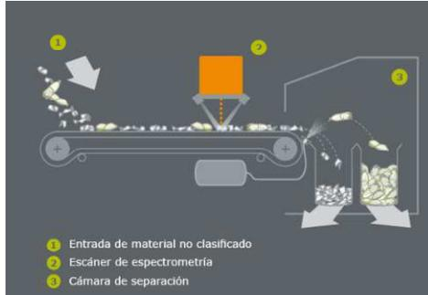
La separación óptica es un sistema de **clasificación multifuncional** que recupera un amplio rango de piezas de material de diferentes masas residuales, monomaterial, embalajes, papel, basura doméstica así como otras tareas de clasificación, mejorando la información y el color del material con combinación.
