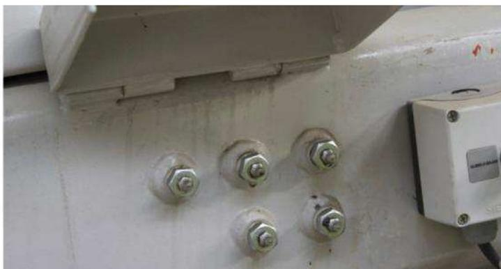
El equipo incorpora en la parte exterior un sistema de engrase centralizado.
