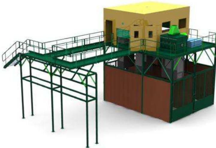
Los paneles son de **chapa de acero grueso con doble capa de lacado**, y la parte interior (entre chapas) con **espuma de poliuretano** para el aislamiento térmico y acústico. Espesor: 70 mm.
