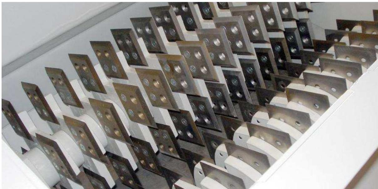
El pinchador de botellas consta de dos ejes independientes. Cada eje es accionado por un motorreductor soportado con un brazo de reacción, lo cual permite tener **velocidades distintas** y lograr una buena perforación de las botellas de PET.
