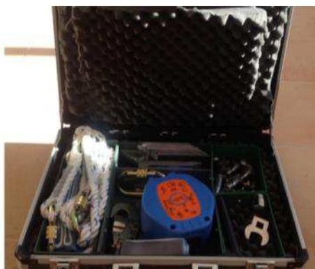
Para facilitar el mantenimiento se incorpora en los laterales del equipo las **herramientas y útiles necesarios** para el cambio y ajuste de las palas.
