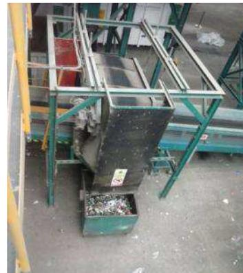
Separador magnético hundido balístico- Línea EELL
