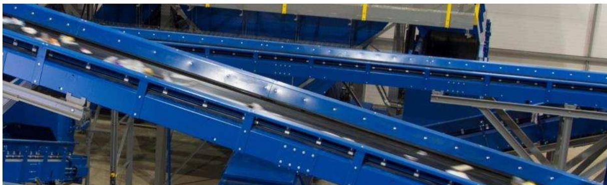
Está conformado modularmente en chasis de chapa doblada. Mediante la unificación de diferentes chasis estándares, juntamente con los cabezales motriz y tensor, conseguimos la longitud deseada para cada transportador.
