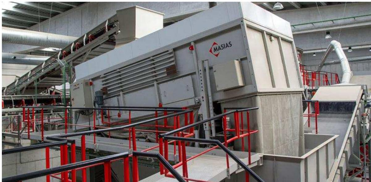
El equipo consiste en una rampa inclinada formada por 8 lamas longitudinales perforadas, que poseen un movimiento de tipo balístico producido por dos cigüeñales ubicados transversalmente en la parte superior e inferior de la rampa.
