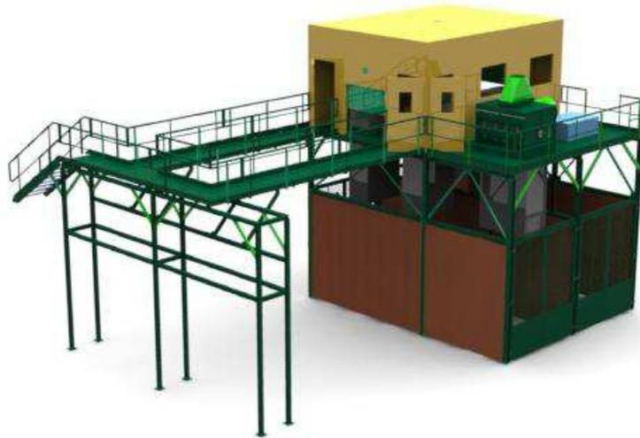
Estas están contruidas con **perfil UPN de 80 mm** y rematadas por la parte superior con chapa de acero de 4 mm. Los perfiles de acero son rígidos y estables y los elementos individuales que conforman la plataforma son de construcción soldada y se fijan a la estructura principal por medio de tornillos. Las bocas de descarga del material seleccionado se encuentran atornilladas a la plataforma.
