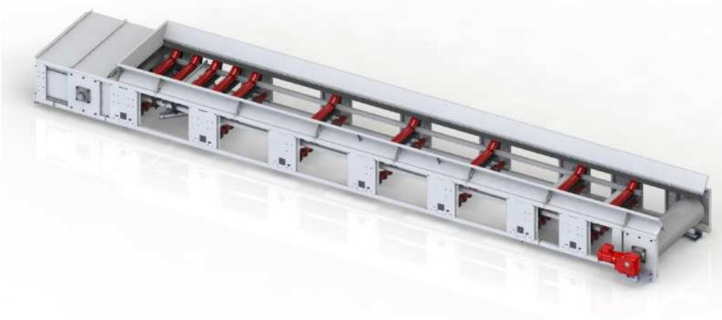
Está conformado por chasis en base de perfiles laminados, soldados entre sí, dando una rigidez y auto-suportación óptimas. Mediante la unificación de diferentes chasis estándares, juntamente con los cabezales motriz y tensor, conseguimos la longitud deseada para cada transportador.
