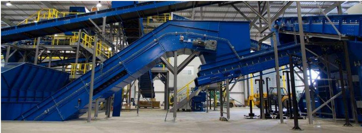
Están fabricados en base **perfiles laminados en caliente y chapa laminada de acero**, con ángulos de refuerzo soldados y **perfiles transversales de unión de UPN 100**, atornillados equidistantes a 250 mm., formando una construcción resistente, rígida y sin flexiones. La unificación de diferentes chasis básicos y/o estándar, juntamente con los cabezales motriz y tensor, conseguimos la longitud deseada para el transportador en cuestión.
