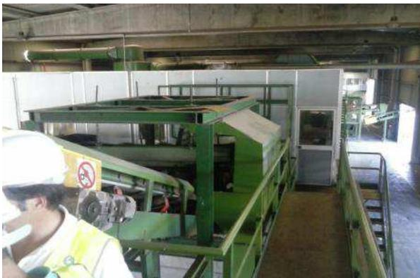
Separador electromagnético- salida triaje línea EELL
