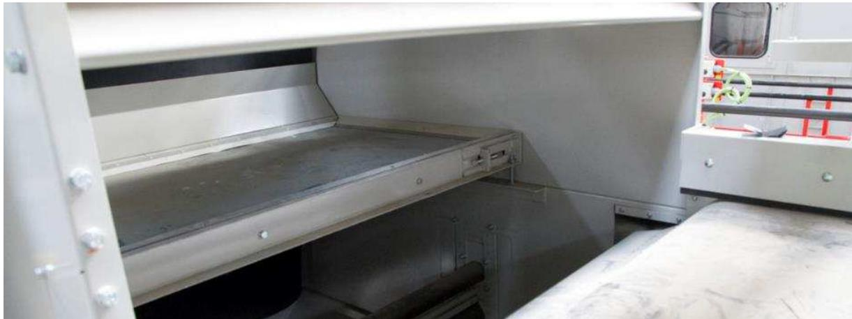
El transportador consta de una banda de poliamida de 2 mm de grosor, que es accionada por un motor y se desliza sobre un chasis conformado por bancadas de chapa.
