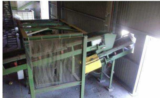
Separador magnético hundido del trómel
