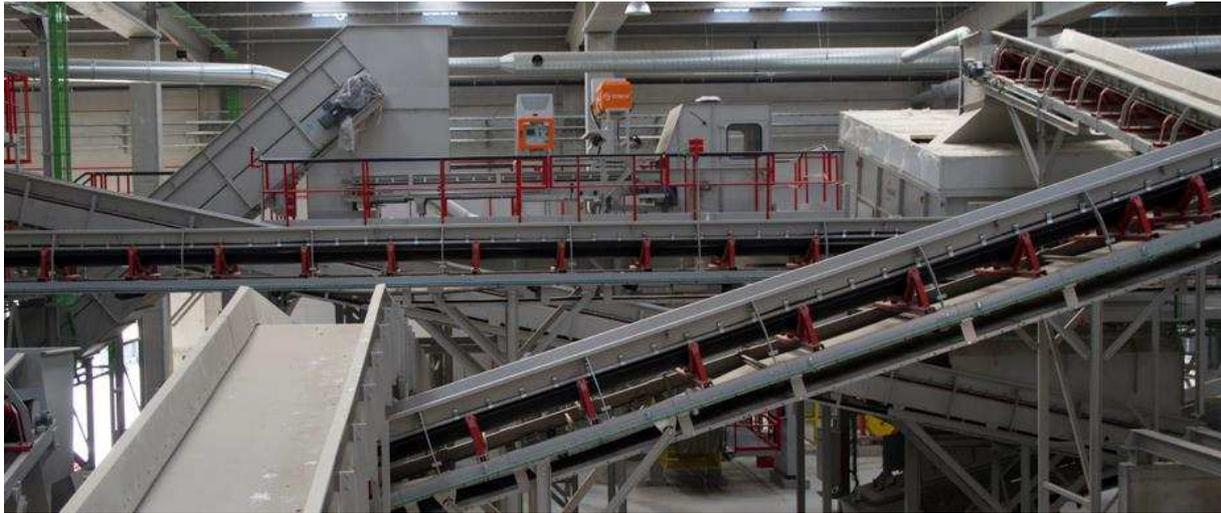
El transportador consta de una banda resistente a grasas y a aceites, que es accionada por un motor-reductor y se desliza sobre un chasis conformado por bancadas de chapa.
