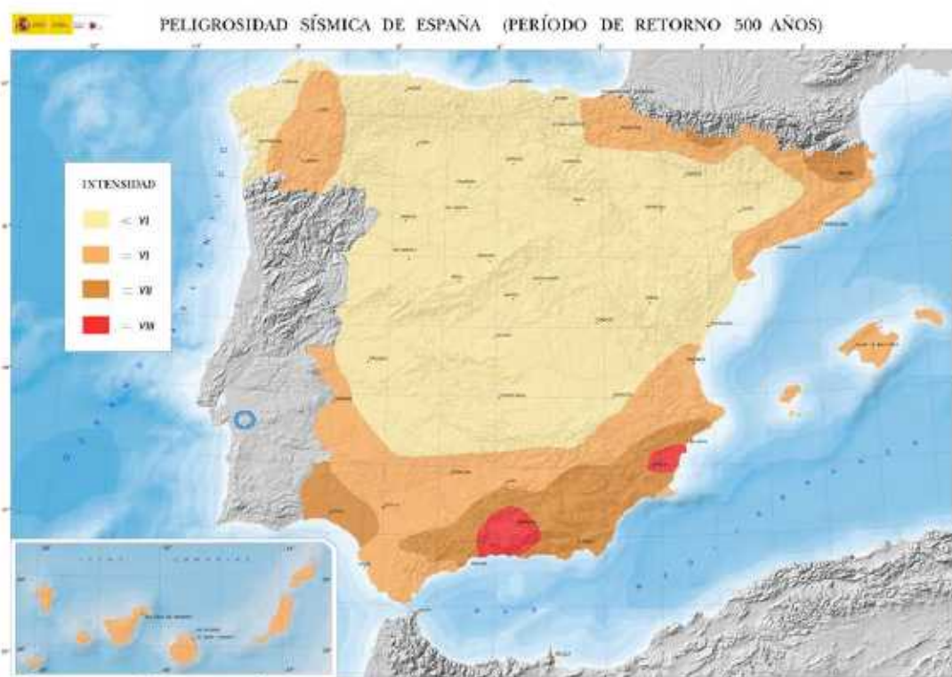
Ilustración 124.- Mapa de peligrosidad sísmica para el período de retorno de 500 años. En azul, ubicación de la planta solar. Fuente: http://www.ign.es
