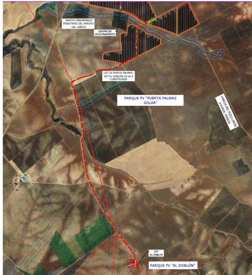
Figura 22.- Layout línea Cs Puerta Palmas- SET El Doblón
