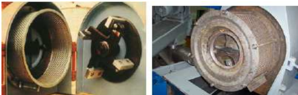
Gráfico 3: Interior de un Molino de Martillo. Fuente: www.asajasev.es .
