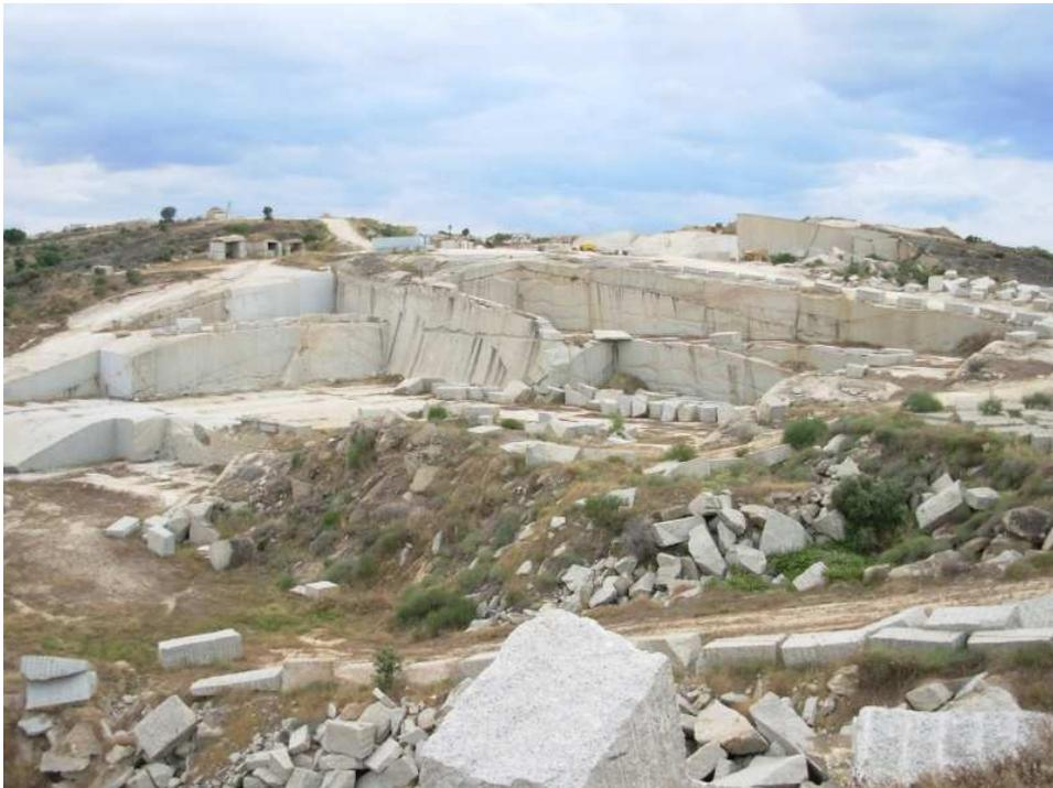
Figura 11. 1. Explotación de Granito en Portezuelo (Cáceres).
